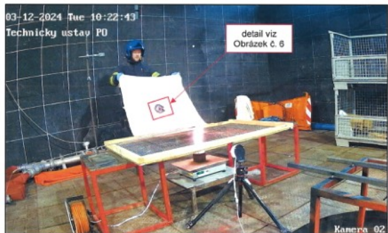
Obrázek č. 5 - Pohled na průběh zkoušky v čase, kdy došlo k prohoření hasební desky a tato byla odstraněna z kovového roštu.
