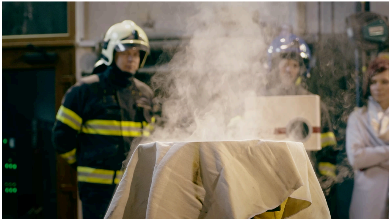
Obrázek č. 5 - Pohled na průběh zkoušky v čase, kdy došlo k prohoření hasební desky a tato byla odstraněna z kovového roštu.
