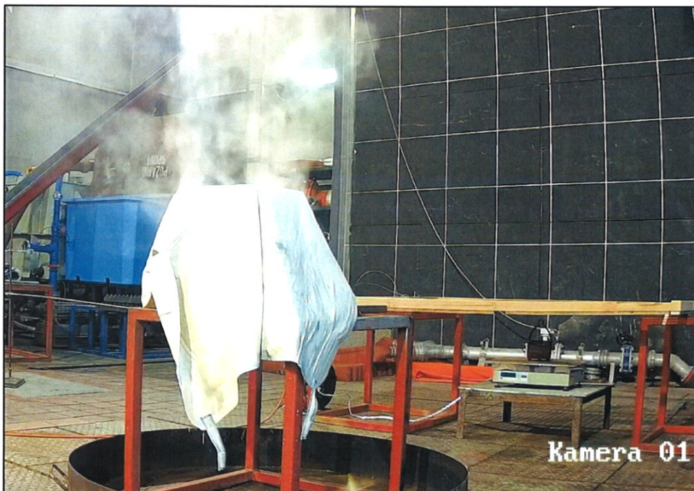
Obrázek č. 10 - Pohled na průběh zkoušky v době, kdy byla hasební deka aplikována na zkušební objekt a došlo k přerušení plamenného hoření.
