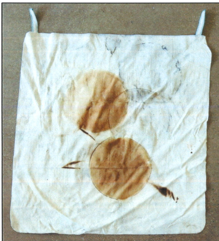
Obrázek č. 11 - Pohled na hasební deku po zkoušce „schopnosti zamezení plamenného hoření“ s viditelnou změnou barvy v místech, která zakrývala zkušební objekt.
