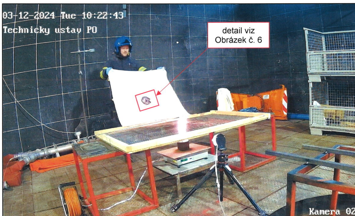
Obrázek č. 5 - Pohled na průběh zkoušky v čase, kdy došlo k prohoření hasební deky a tato byla odstraněna z kovového roštu.
