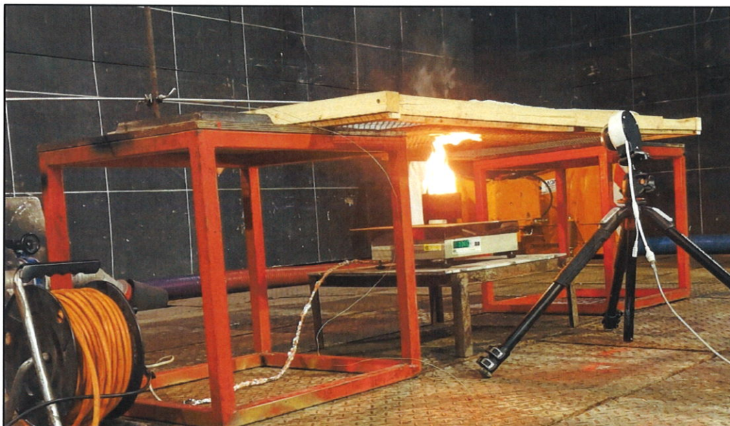
Obrázek č. 2 - Pohled na probíhající zkoušku tepelné prostupnosti hasební deky.
